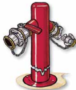
Hidrante de columna
