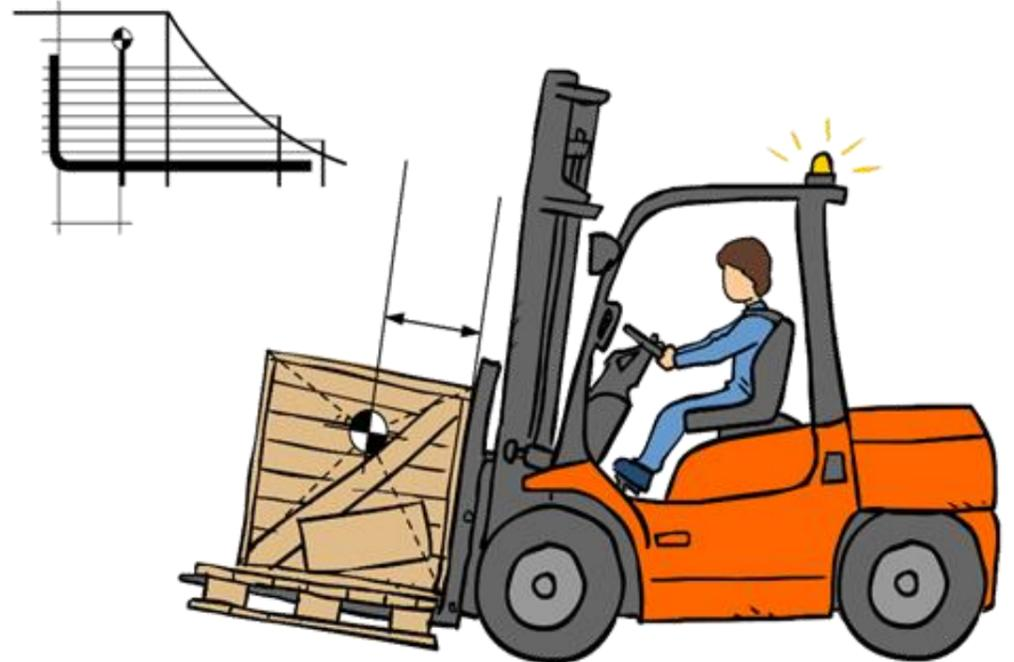
2. Circula siempre con las horquillas en posición baja y a una distancia de 15-25 cm del suelo.
