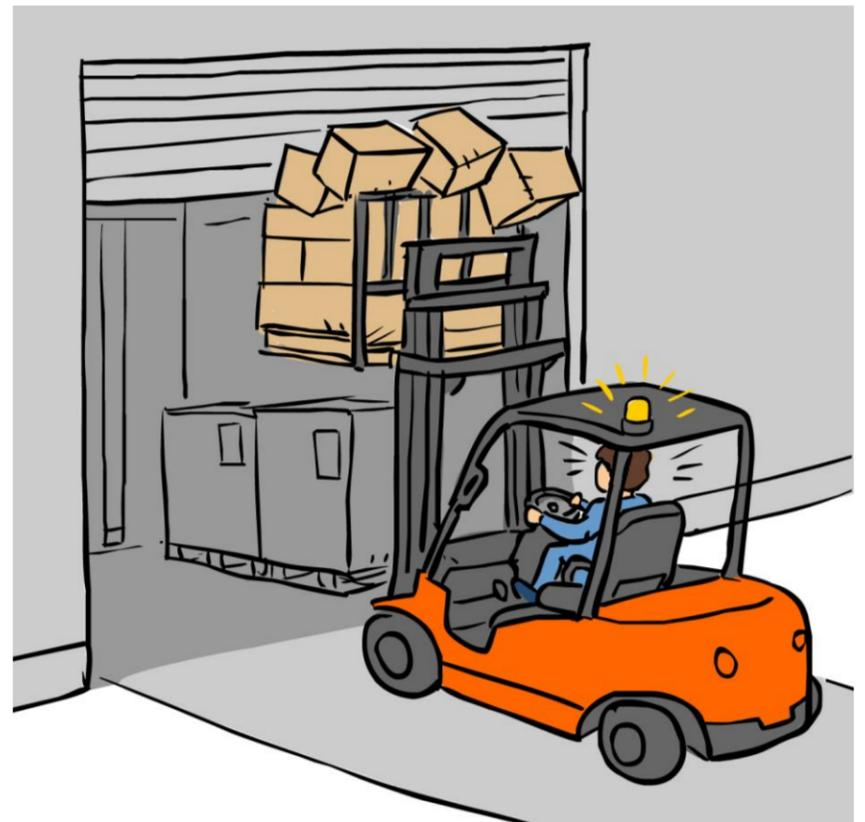
3. No circules con la carga levantada.
