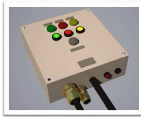
Entradas de cables incorrectas Ausencia de tornillos en envolventes
